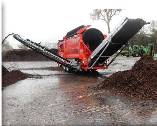
*En la fase de cribado se obtiene compost y un residuo que puede utilizarse como mulching o acolchado vegetal*
