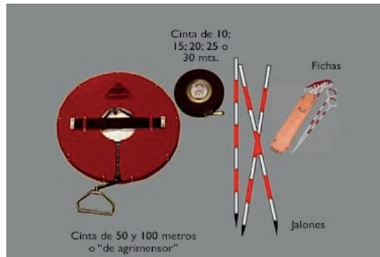
Elementos topográficos simples para utilizar en la medición de una parcela con jalones y cinta métrica.
